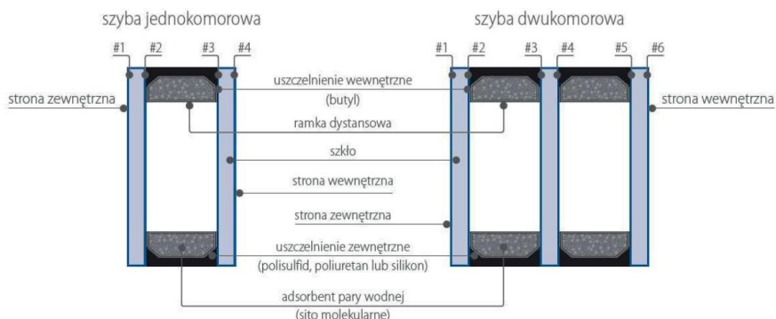
Rys. 1. Budowa szyby jednokomorowej i dwukomorowej z oznaczeniem części składowych i pozycji szkła
